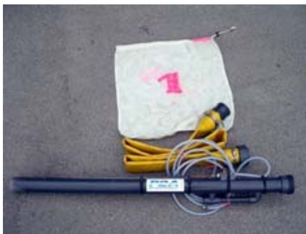
Figure 3. Aspirateur Air-Lift 10 m 3 conçu spécifiquement pour la présente opération de sondages à - 60 cm.
