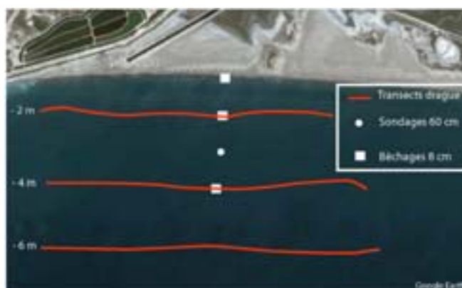
Figure 3. Représentation de l'ensemble du dispositif d'échantillonnage pour une zone : 2 axes sont étudiés en détail, la répartition spatiale le long de transect parallèles à la côte et la répartition bathymétrique entre 2 et 6 m. Les sondages n'ont pas été reconduits pour la campagne saison chaude,
