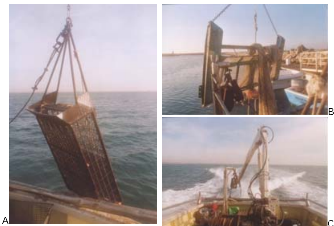
Figure 1. Prises de vue du dispositif de prélèvement à la drague à coquillages : A – Drague 62 qui a été validée pour la campagne de prélèvement, B – Drague 180 qui a été éliminée lors des tests de validation de l'échantillonnage et C – Vue du pont arrière avec les équipements hydrauliques nécessaires aux opérations, treuil 2 tonnes, portique à fune et grue articulée 500 kg.
